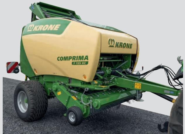
est plus facile par rapport à une presse à balles rondes à chambre variable. Elle est en mesure de presser des balles de différents diamètres, compressées de l'extérieur vers l'intérieur et offre pour les grands diamètres de balles un noyau très petit et souple. Avec pour résultat des poids élevés de balles.
